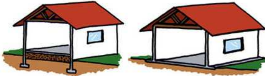
deux types de fondations : profondes et superficielles
